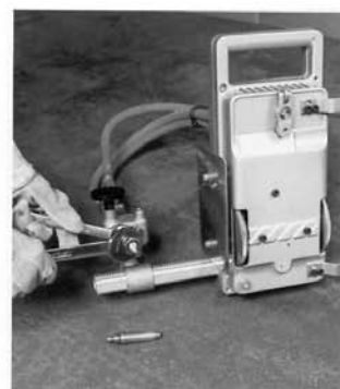
Łatwa wymiana dysz w urządzeniu IMP
