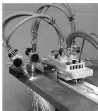
IMP do ukosowania z jednostronnie umieszczonym palnikiem
